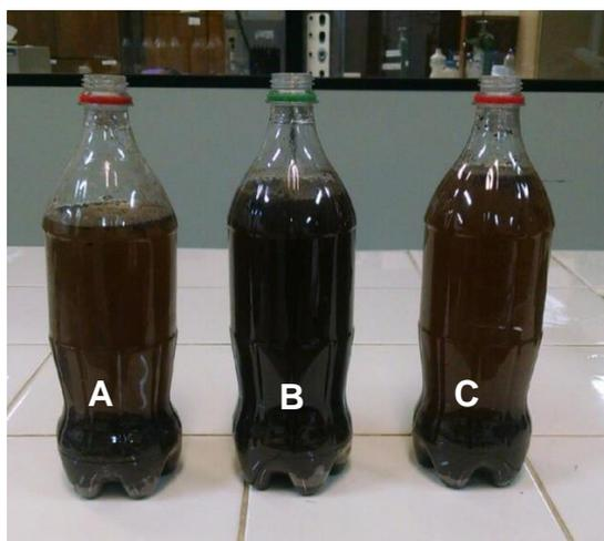
**Figura 7. Inoculação das diferentes massas de cama de frango juntamente com água destilada e dejetos suínos. (A) Massa de 50g de cama de frango. (B) Massa de 80g de cama de frango. (C) Massa de 100g de cama de frango.**
