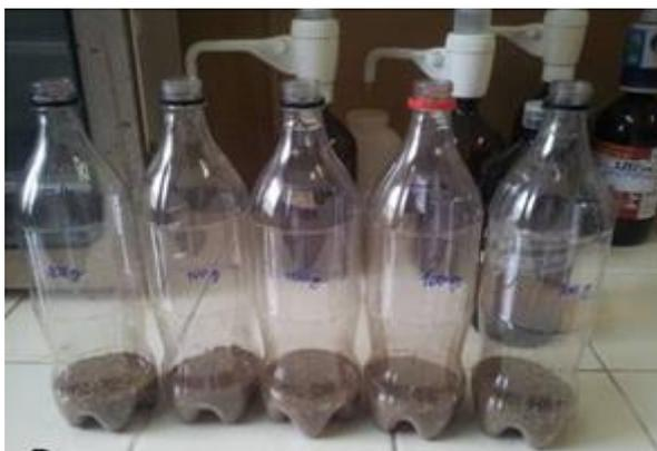
**Figura 4. Modelo de garrafa PET de 1 litro utilizada nos ensaios da AME.**
