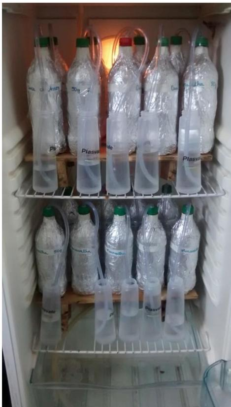
**Figura 8. Biorreatores com a solução de NaOH a 15%.**
