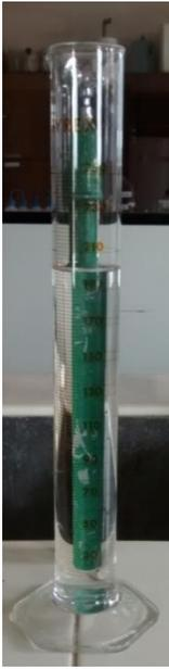
**Figura 9. Proveta graduada com 200 mL de solução de NaOH a 15%.**
