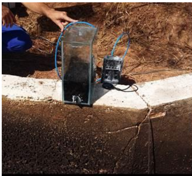
Figura 3. Filtro montado no T da calha de lançamento do efluente para o Rio.
