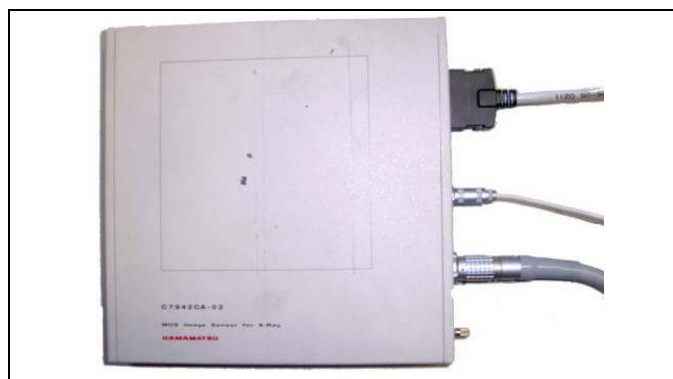
Figura 43 - Detector de raios X fabricante HAMAMATSU Fonte: (RIBEIRO JÚNIOR, 2008).
