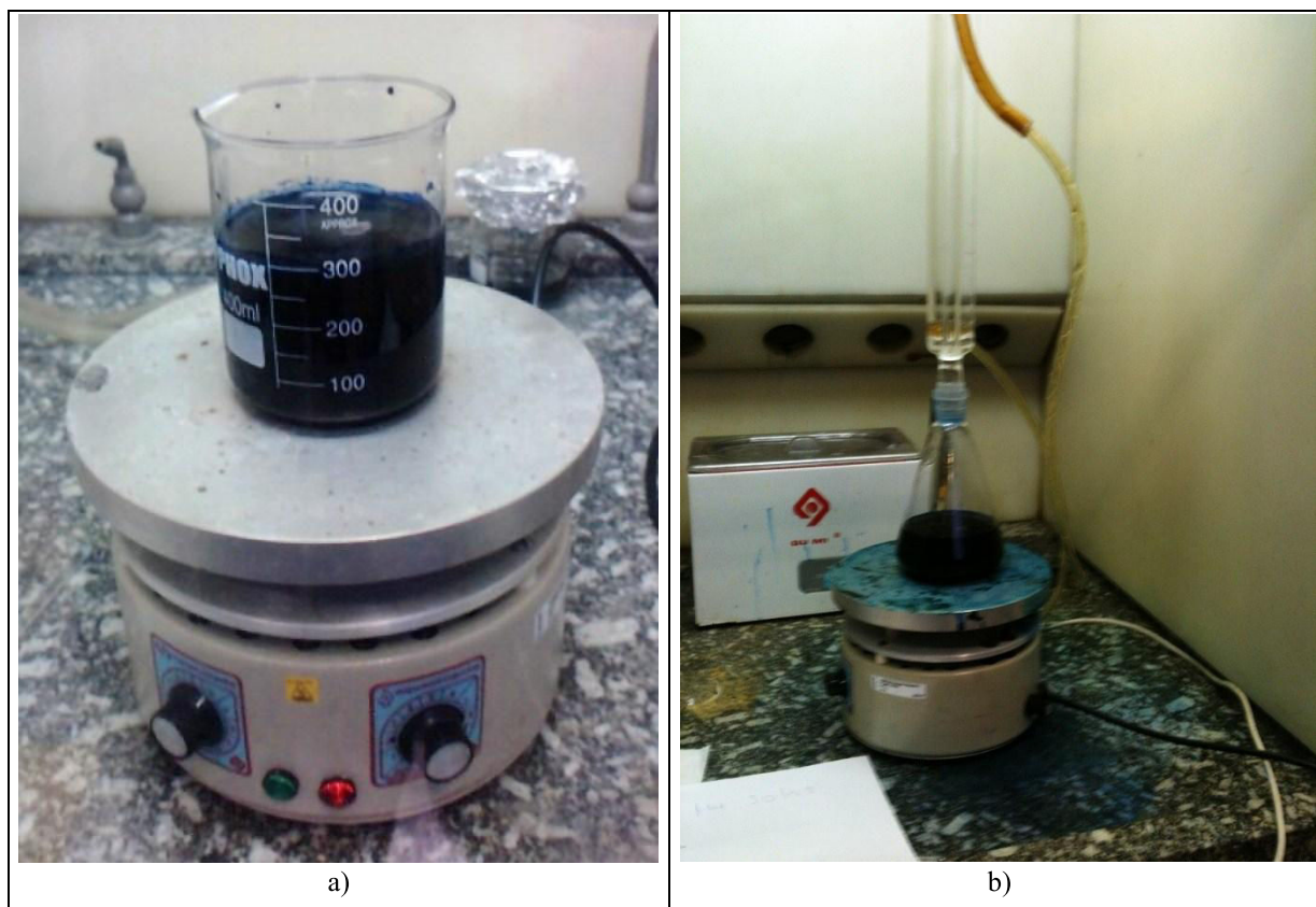
Figura 35 - Solução de coloração das amostras em aquecimento a) Montagem do sistema com misturador, b) montagem do sistema com condensador e misturador.
