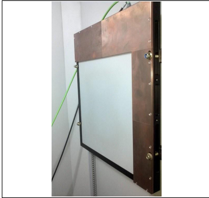
Figura 45 - Detector de raios X fabricante PERKINELMER .
