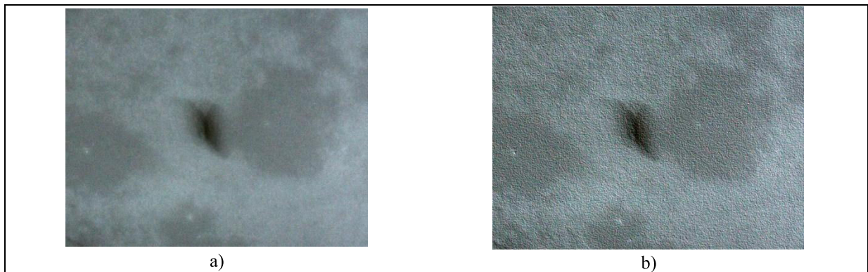
Figura 145 - Filme radiográfico de amostra de lençol de borracha natural EPR com energia de 20 kVp, a) filme radiográfico, b) com filtro de detecção de bordas.
