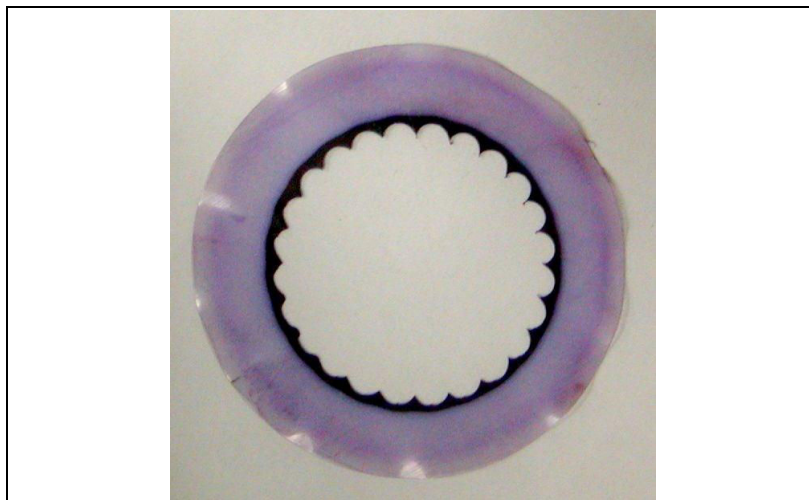
Figura 34 - Amostra de cabo preparado para análise de arborescência Fonte: (RIBEIRO JÚNIOR, 2008).
