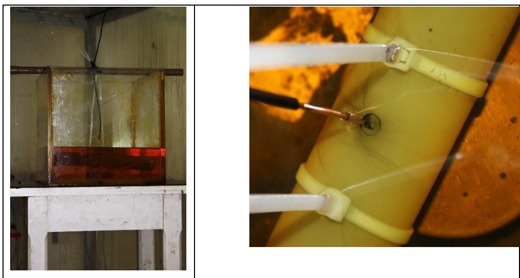
Figura 29 - Montagem da amostra no ensaio de rigidez dielétrica.
