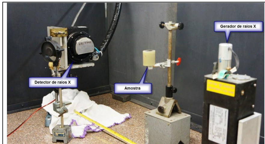
Figura 49 - Detector de raios X fabricante Princeton Instruments.
