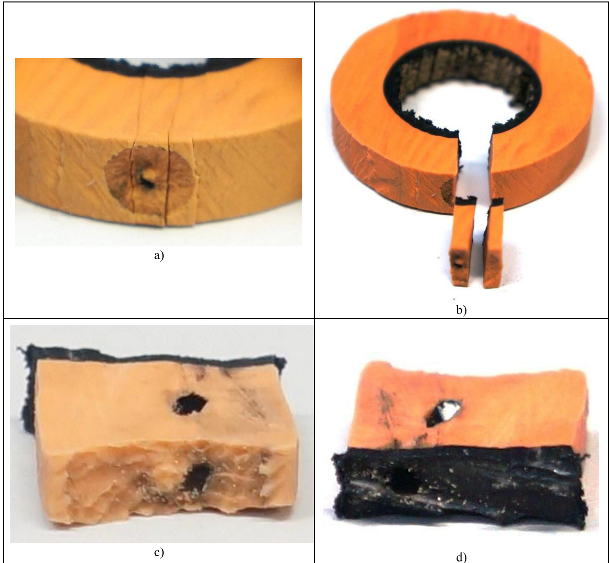
Figura 65 - Amostra 7 de cabo com isolamento em EPR, a) vista diagonal, b) visão diagonal da retirada dos corpos de prova, c) corpo de prova com caminho de ruptura inicial, d) corpo de prova com caminho de ruptura final.
