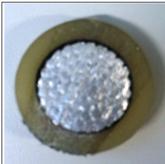
Figura 63 - Amostra 4 de cabo isolado com XLPE.
