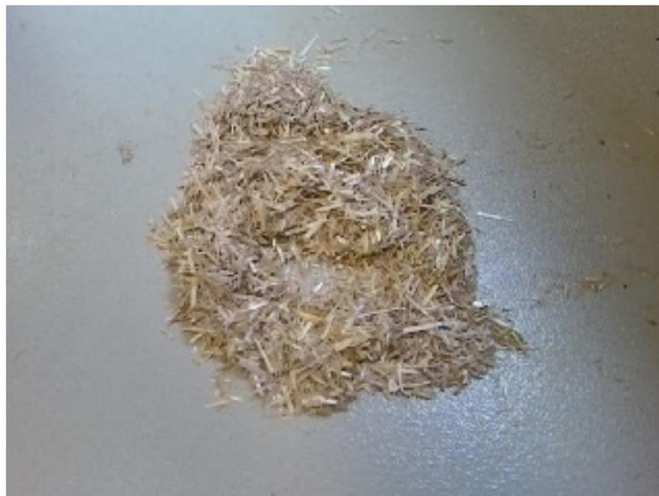
**Figura 7 - Palha de milho após a passagem pelo moinho de facas.**
