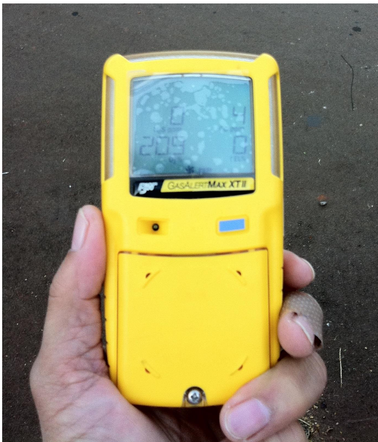
Figura 3: Detector de gás portátil, modelo Gás Alert MAX XT II, fabricado por BW Technologies.
