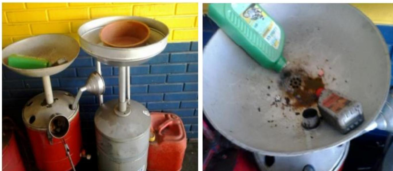
**Figura 11 – Sistema de escoamento do óleo lubrificante.**
