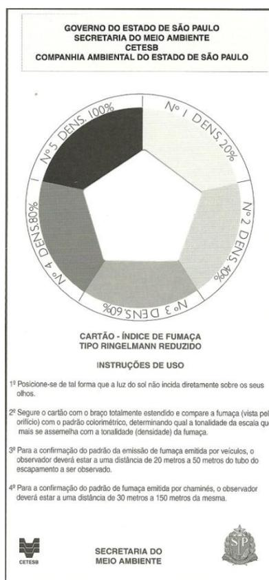
Figura 4 — Escala de Ringelmann utilizada para visualizar a densidade aparente da fumaça
