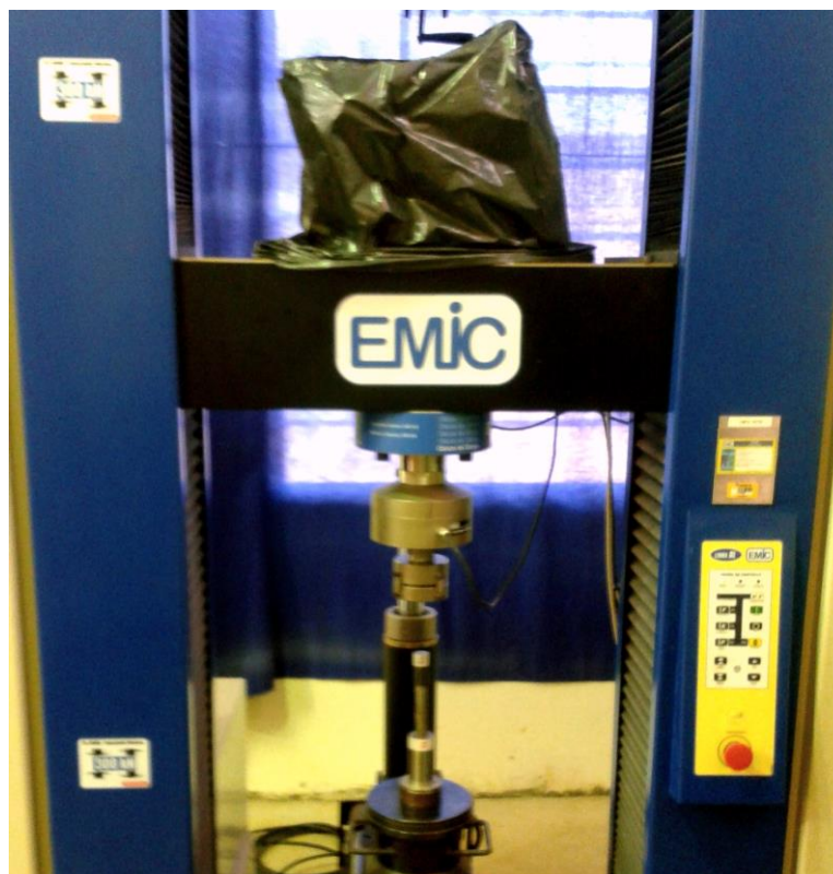
Figura 2. Prensa hidráulica (EMIC) utilizada para confecção dos corpos de prova
