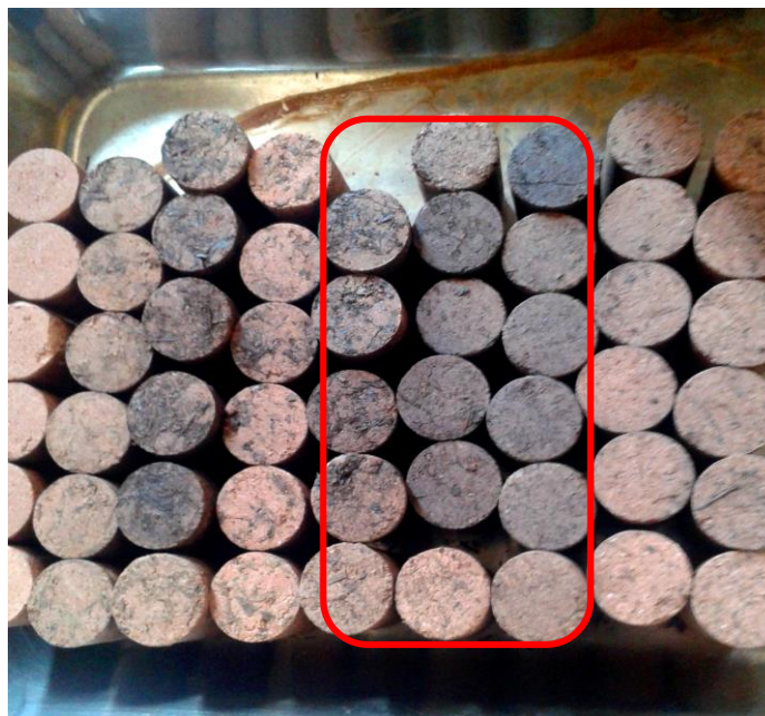
Figura 5. Corpos de prova pós queima com destaque para aqueles sintetizados com 10% de folhas de P. parviflora e 10% de raízes de T. domingensis 5.3.7 Limite de liquidez
