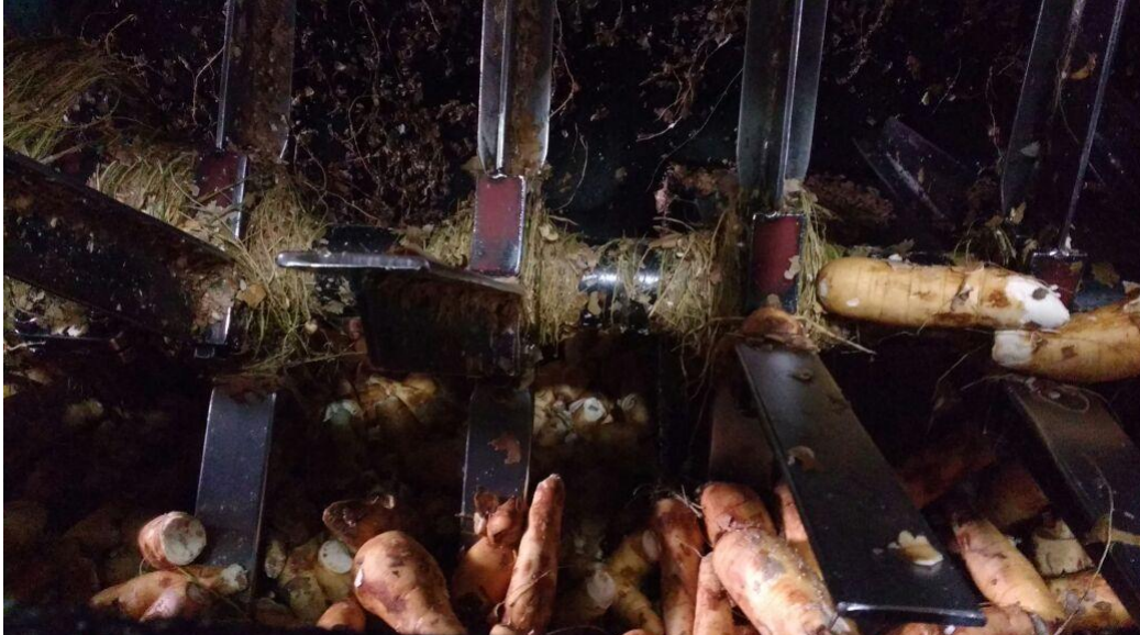
Figura 5 – Lavador mecânico da farinha em estudo
