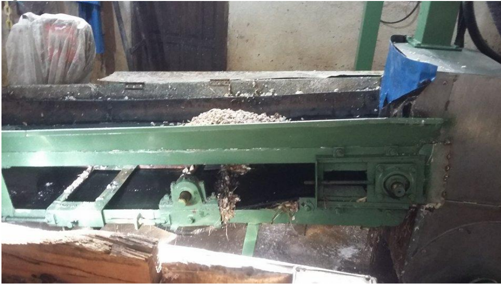
Figura 7 – Picador mecânico da farinha em estudo
