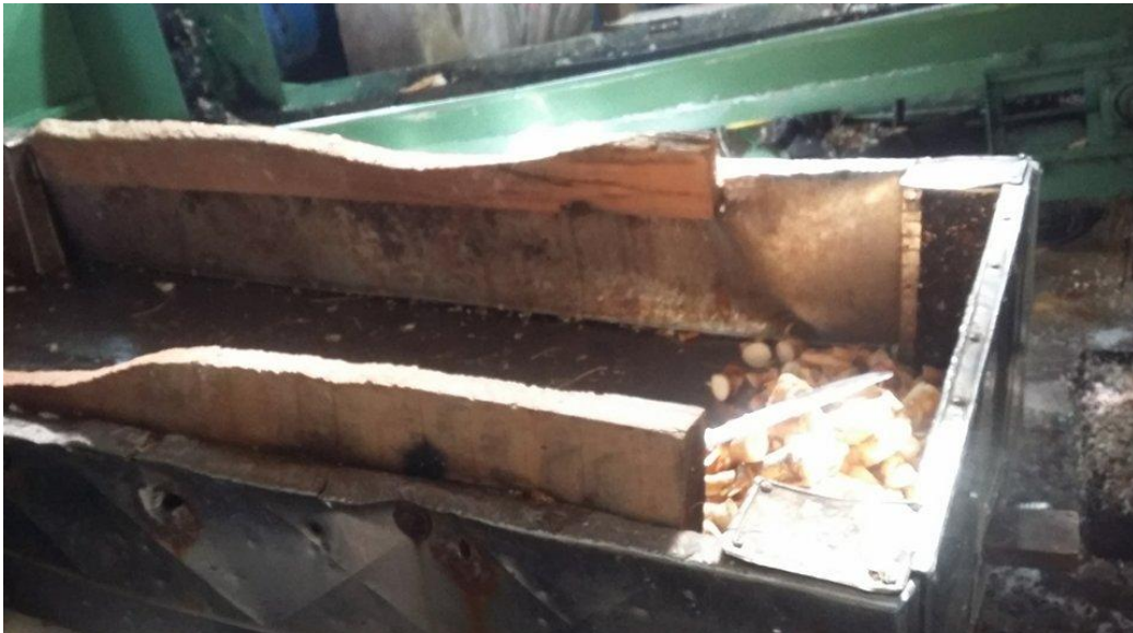
Figura 6 – Retirada de cascas e películas que sobraram na lavagem e descascamento mecânico das raízes
