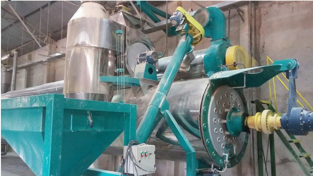
Figura 12 – Forno rotativo torrador da farinha em estudo
