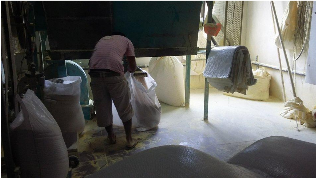
Figura 14 – Peneiramento e empacotamento da farinha produzida na farinha em estudo
