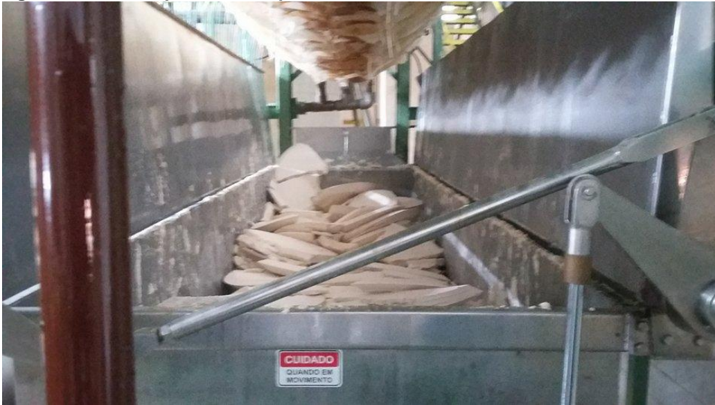
Figura 11 – Massa prensada na prensa mecânica da farinha em estudo
