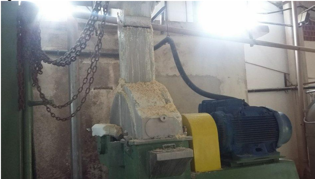
Figura 8 – Triturador mecânico da farinha em estudo
