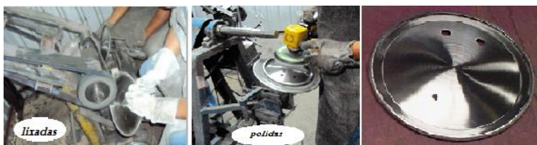
Figura 13 - Lixamento e polimento dos discos Fonte: Autoria própria
