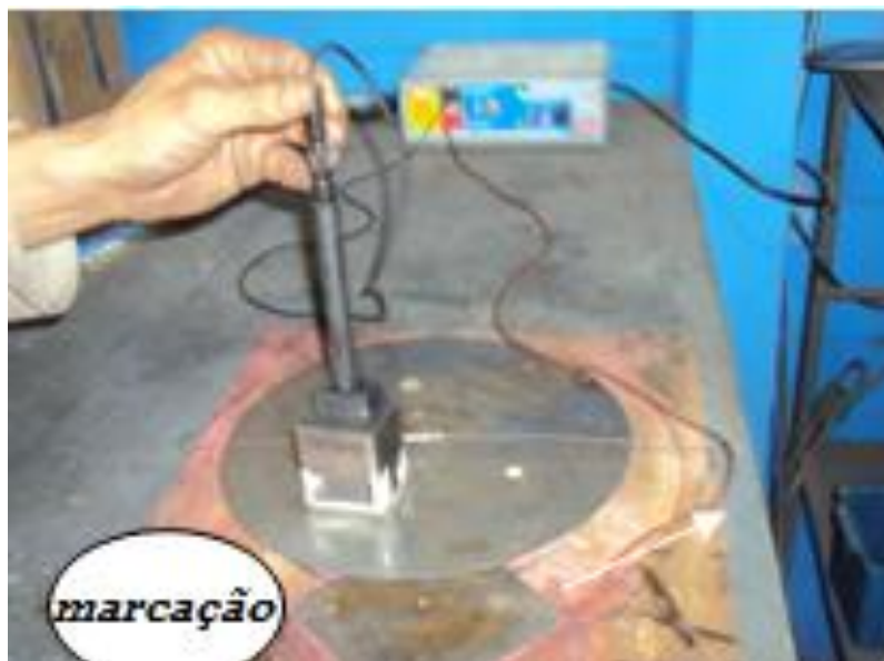
Figura 10 - Marcação dos discos por carimbos elétrico-magnético Fonte: Autoria própria
