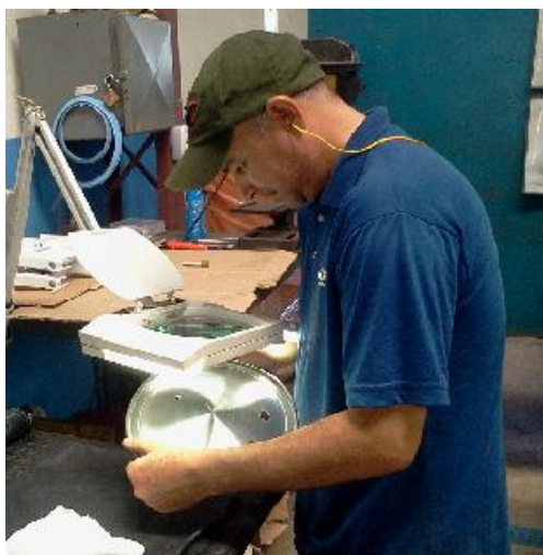
Figura 14 - Inspeção das tampas. Fonte: Autoria própria
