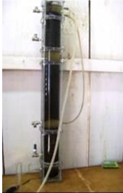
Figura 2 - Reator anaeróbio de leito fixo e escoamento ascendente. Fonte: Própria autoria, 2011.
