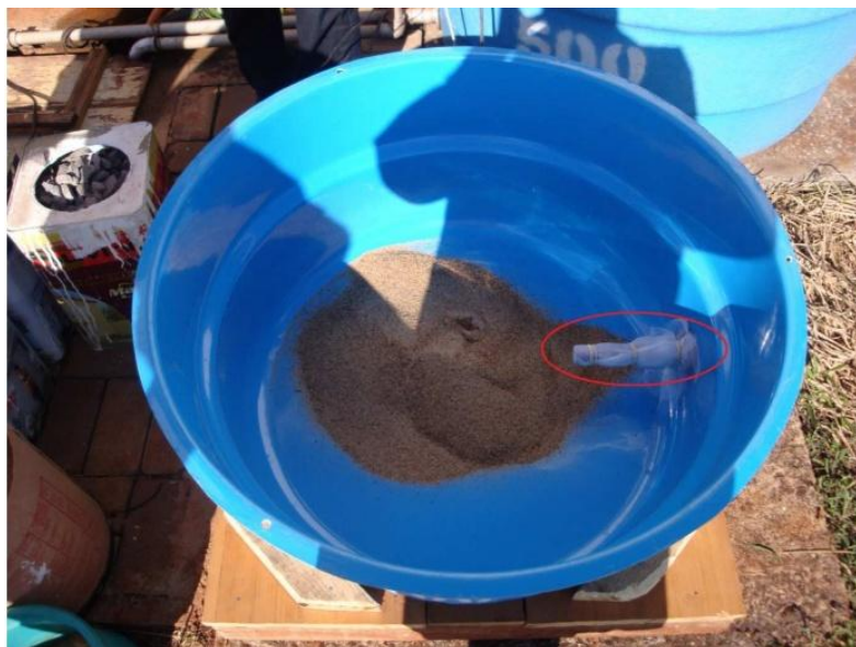
Figura 6 - Piloto, com a caixa d'água sendo coberta pelos meios filtrantes e com destaque para o cano de pvc.
