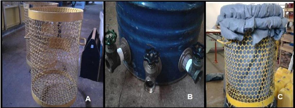
**Figura 4 – Dispositivos do leito de secagem modificado, estrutura metálica (A), dispositivo de armazenamento de lodo (B), dispositivo com manta geotêxtil (C)**
