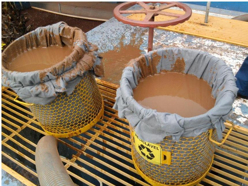
**Figura 5 - Coleta do lodo na saída de descarga do decantador**
