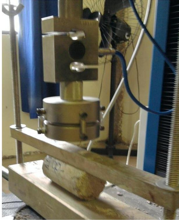
Figura 9 - Ensaio de Compressão diametral
