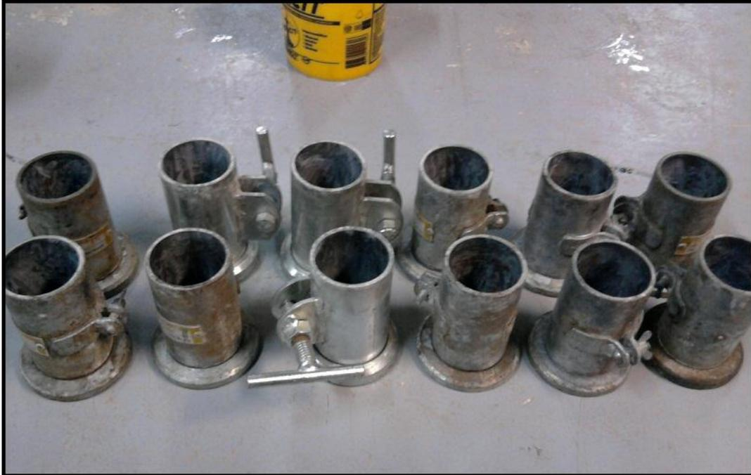
**Figura 7- Moldes metálicos dos CPs**
