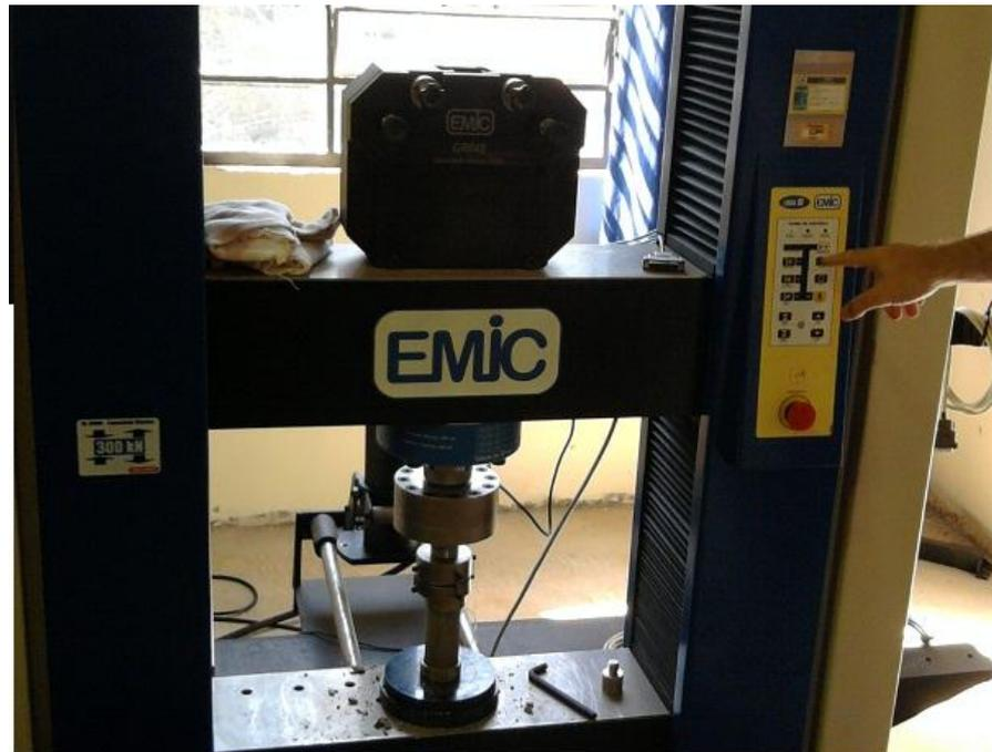
**Figura 8 - Ensaio de compressão axial**
