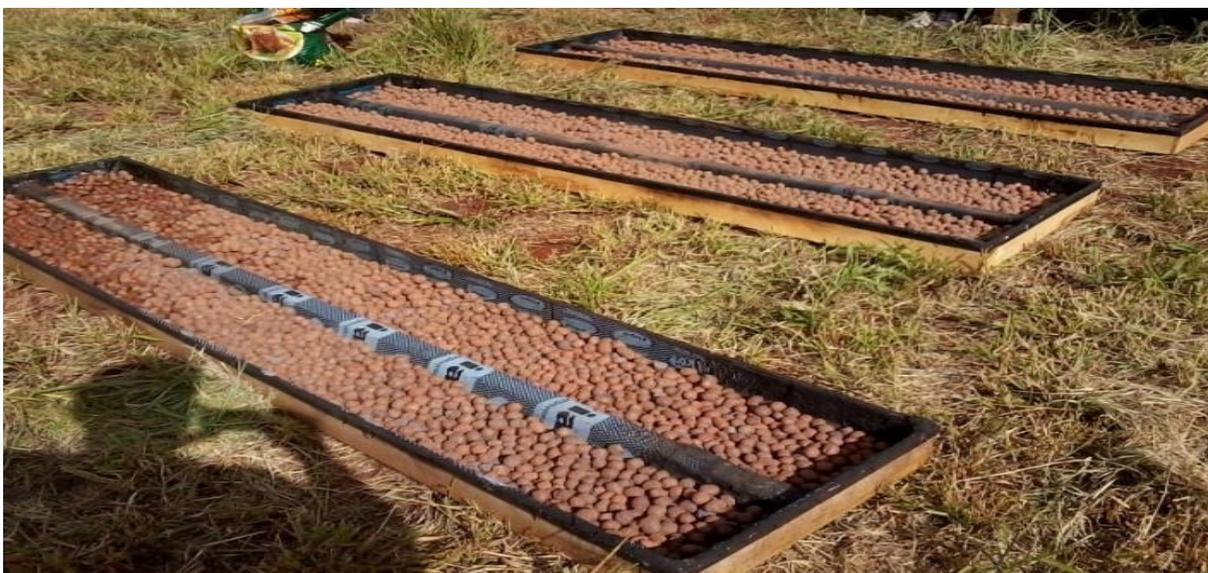
Figura 3 - Módulos que foram utilizados nos telhados verdes. Fonte: Acervo do Autor, (2014).
