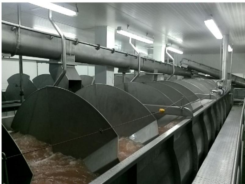
**Figura 21** – Movimentação e borbulhamento do Tanque “chiller” para resfriamento de carcaças por imersão em água e gelo.
