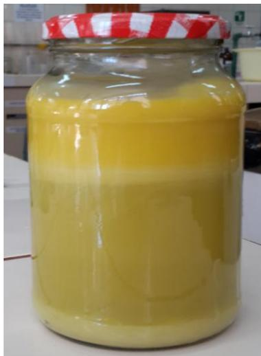
Figura 8 – Glicerina resultante da transesterificação para produção do biodiesel
