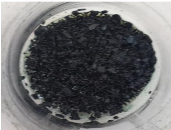
Figura 9 – Catalisador heterogêneo a partir de óxido de molibdato lavado pelo álcool no processo de transesterificação
