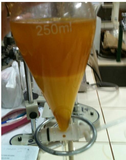
Figura 6 – Separação do biodiesel e da glicerina utilizando catalisador homogêneo
