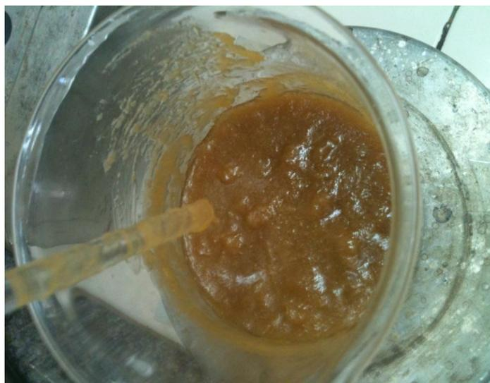
Figura 5 – Processo de saponificação do biodiesel com 1% de NaOH
