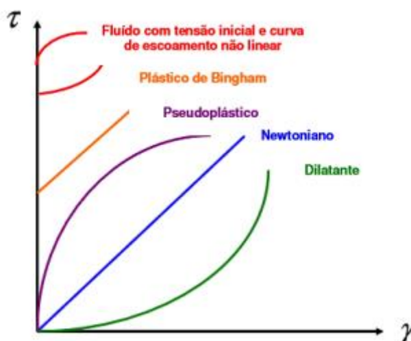
Figura 1 - Curvas de fluxo para diferentes tipos de fluidos. Onde: \tau = Tensão de cisalhamento (Pa) e \gamma = Taxa de cisalhamento ( s^{-1} ).
