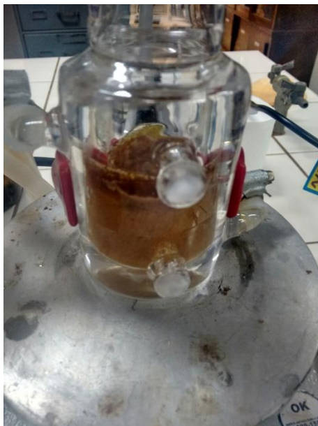
Figura 6. O reator contém água sem ser acidificada, com argila KSF e óleo de macaúba.
