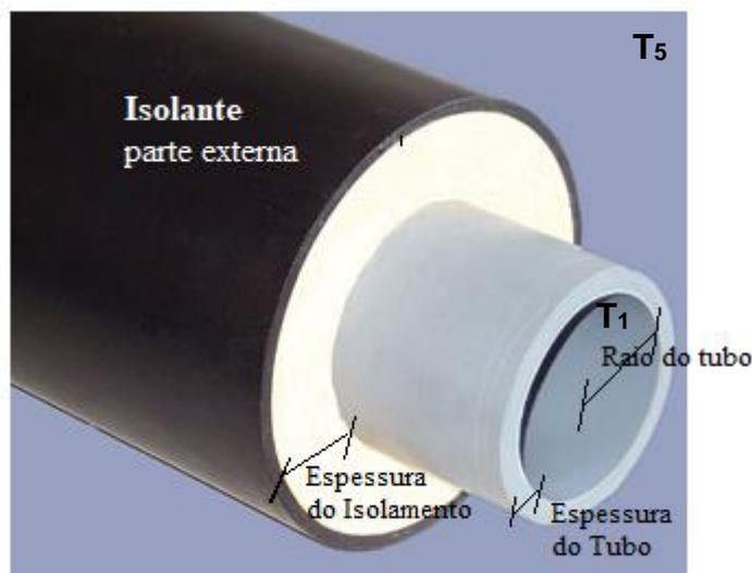
**Figura 13.** Corte esquemático de um tubo espesso revestido por isolamento térmico.
