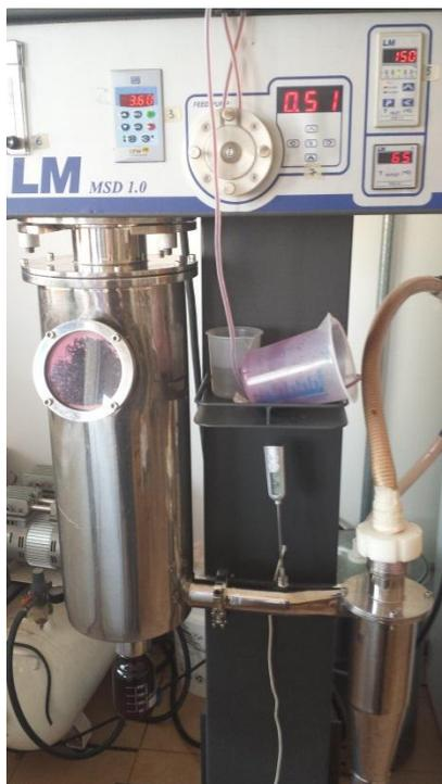
**Figura 4-** *Spray dryer* utilizado nos ensaios de secagem.
