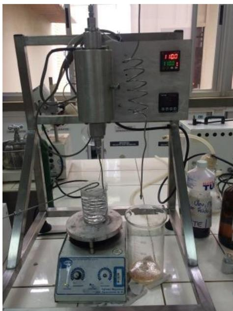
O reator foi preenchido somente com catalisador, de modo que 10,5 g de catalisador preenche toda parte interna do reator. Peneiras em aço inox ficam compreendidas entre entrada e saída do reator, evitando assim que o catalisador saia em uma das regiões de delimitação migrando para a tubulação, conforme Figura 6.
