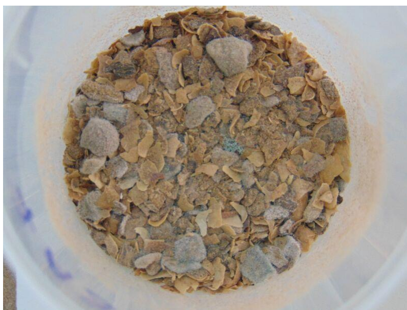
Figura 3 - Desenvolvimento de fungos na casca de café mantida em ambiente fechado com solução salina saturada de KCl e umidade relativa de 75%.
