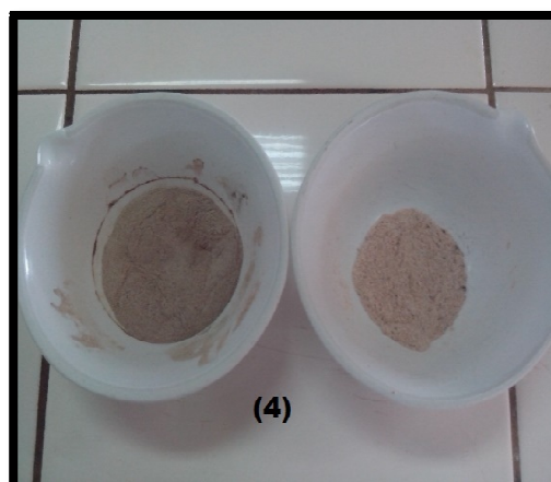
Figura 3: Casca de trigo/arroz após a 1ª secagem na estufa. Figura 4: Sílica arroz/trigo após tratamento duplo.
