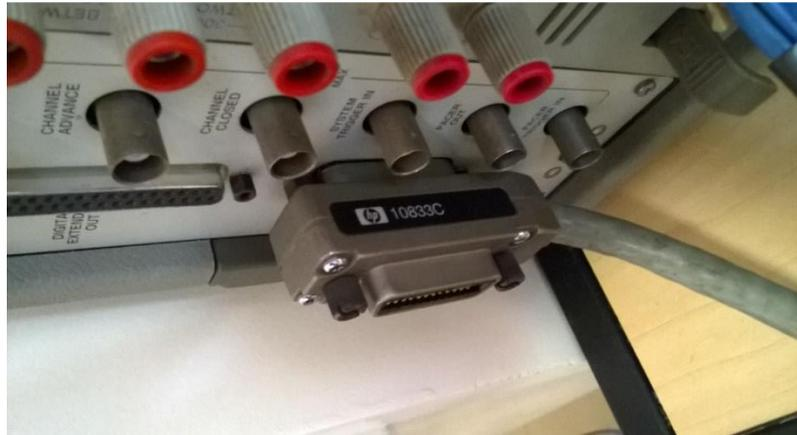
**Figura 9:** Cabo de conexão GPIB utilizado no módulo termoeletrico.
