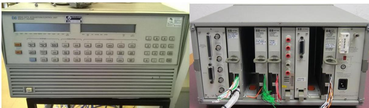
**Figura 8:** Equipamento de aquisição de dados HP3852A.
