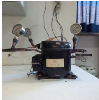
Figura 29: Manômetros de alta e baixa pressão do módulo.
