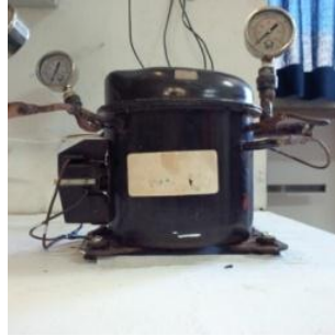
Figura 26: Compressor acoplado no módulo.
