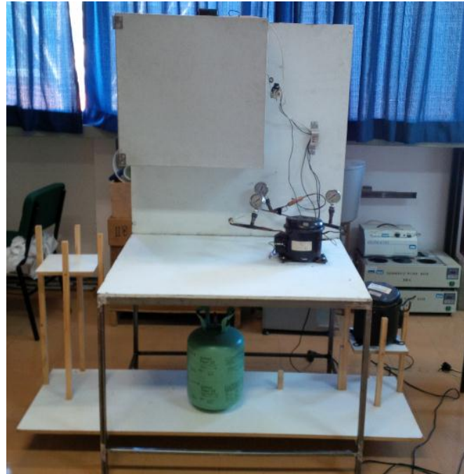
Figura 32: Módulo para estudos práticos de sistemas de refrigeração mecânica por compressão.
