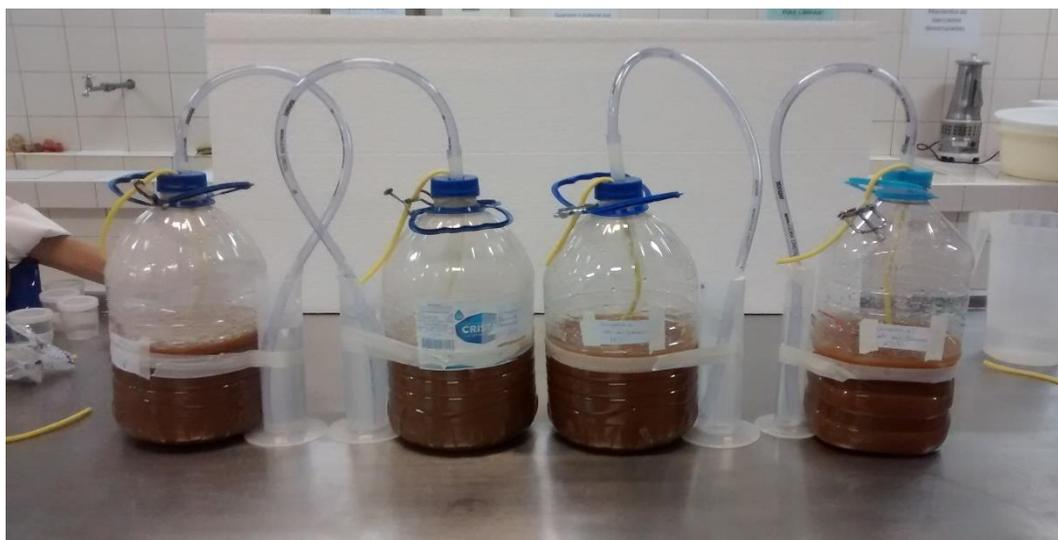
Figura 2 - Fermentador: garrafas PET, com sistema para liberação de CO<sub>2</sub> e retirada de amostra.
