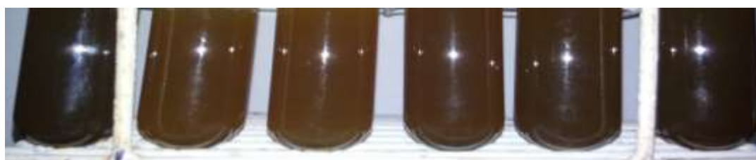
Figura 6 - Pré-tratamento do melaço diluído (Sendo da esquerda para a direita: Diluição do melaço a 100 g/L; Ajuste térmico à 55°C; Ajuste do pH para 4,55; 5 minutos de reação enzimática; 10 minutos de reação enzimática; 20 minutos de reação enzimática).
