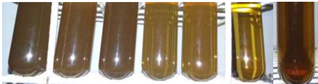
Figura 7 - Pré-tratamento do melão diluído (Sendo da esquerda para a direita: 30 minutos de reação enzimática; 40 minutos de reação enzimática; 60 minutos de reação enzimática; 80 minutos de reação enzimática; após tratamento com carvão ativado 80 gramas por litro de solução submetido à 90°C por 1 hora; após ultrafiltração em temperatura ambiente; após esterilização a 121°C por 15 minutos).
