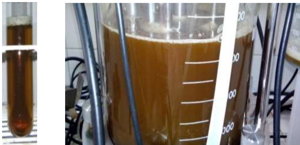
Figura 12 – À esquerda: amostra retirada antes do bioprocesso límpido e com coloração escura. A direita: Biorreator com substrato turvo e de coloração diferente, comparada à inicial.
