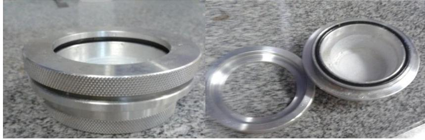
**Figura 4** Cápsulas herméticas de Alumínio para análise de PVA.
