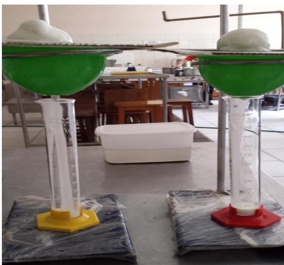
**Figura 2.** Esquema ilustrativo do teste de derretimento.
