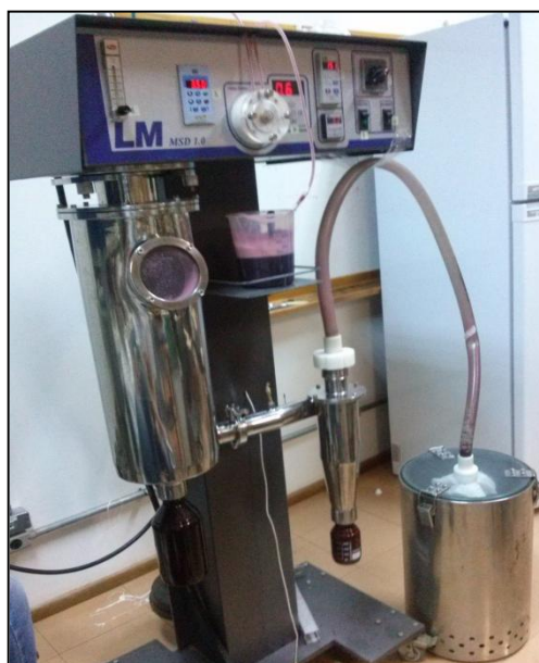
Figura 4: Spray dryer piloto utilizado nos ensaios de secagem realizados neste trabalho
