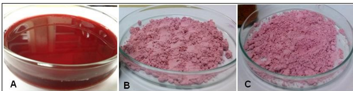
Figura 5: Polpas de amora-preta utilizadas neste trabalho: A) polpa integral; B) polpa encapsulada com maltodextrina; C) polpa encapsulada com goma arábica
