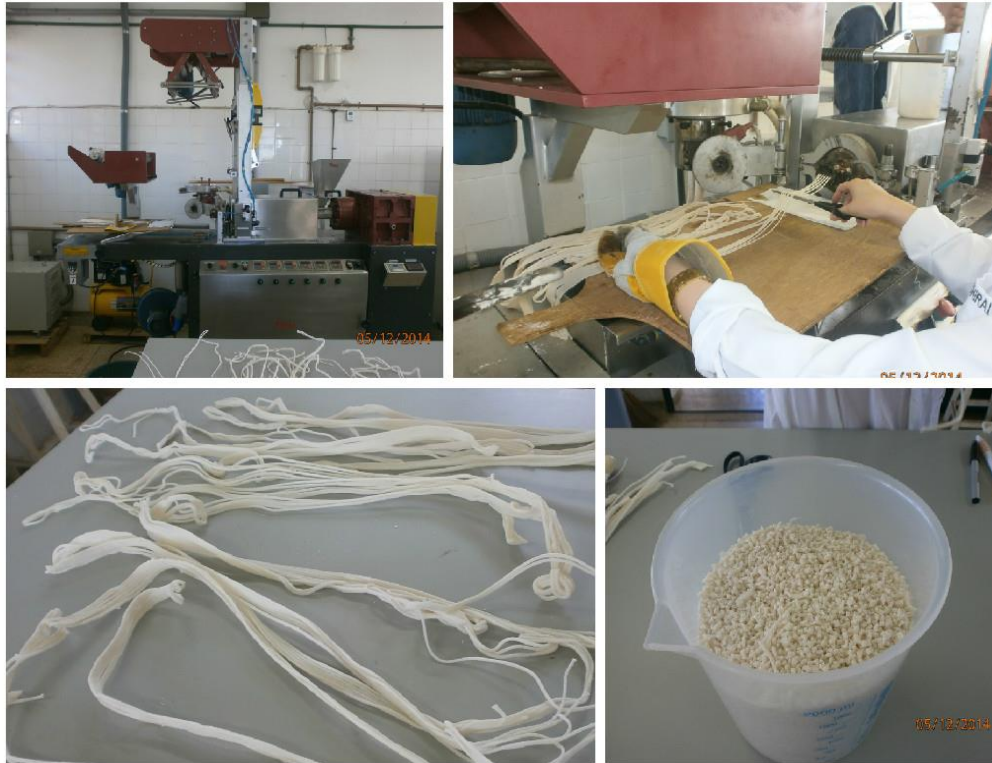
Figura 1 – Processo de extrusão formando filamentos cilíndricos e os peletes. Fonte: Autoria Própria
