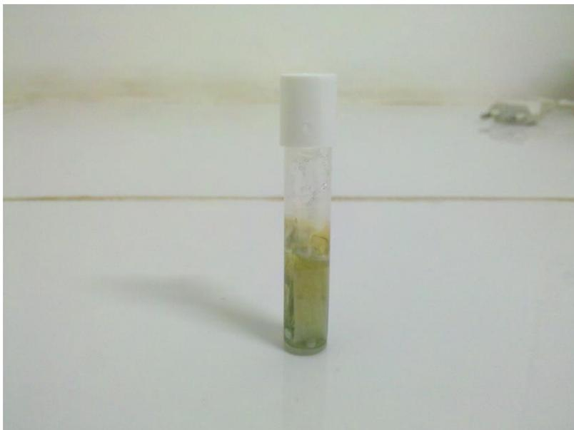
Figura 5: IB com mudança de coloração pela evaporação do ácido e falta de nutrientes antes das 48h.
