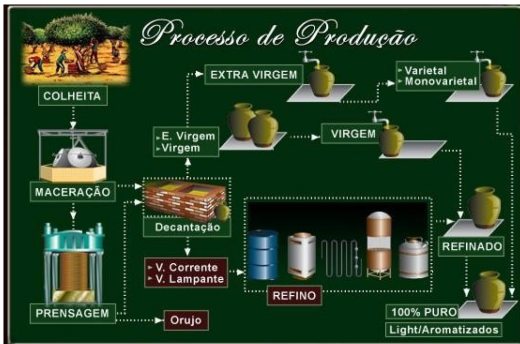
FIGURA 1 _ PROCESSO DE PRODUÇÃO DO AZEITE DE OLIVA.
