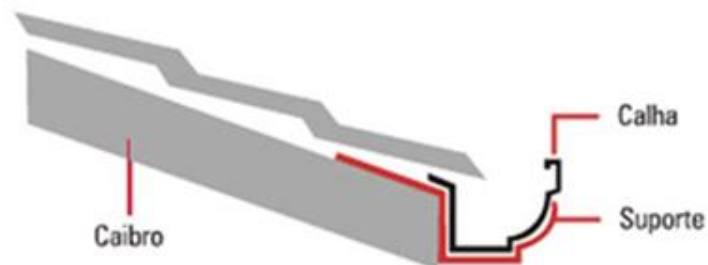
Figura 9: Ilustração do suporte para calha em um telhado Fonte: Catálogo de calhas CALHAFORTE
