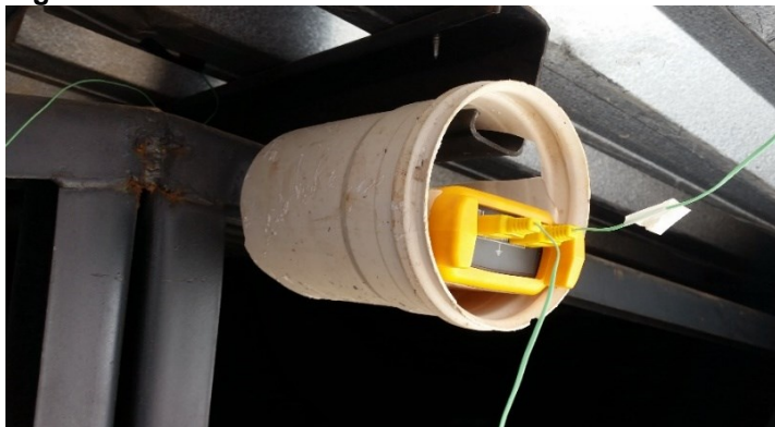
Figura 11 – Posicionamento do termômetro na cobertura A.
