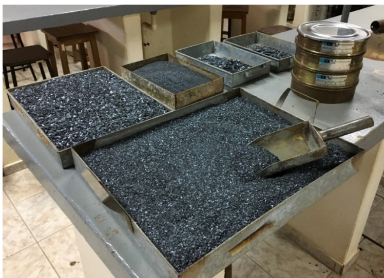
Figura 2 – Separação da granulometria ideal da carepa
