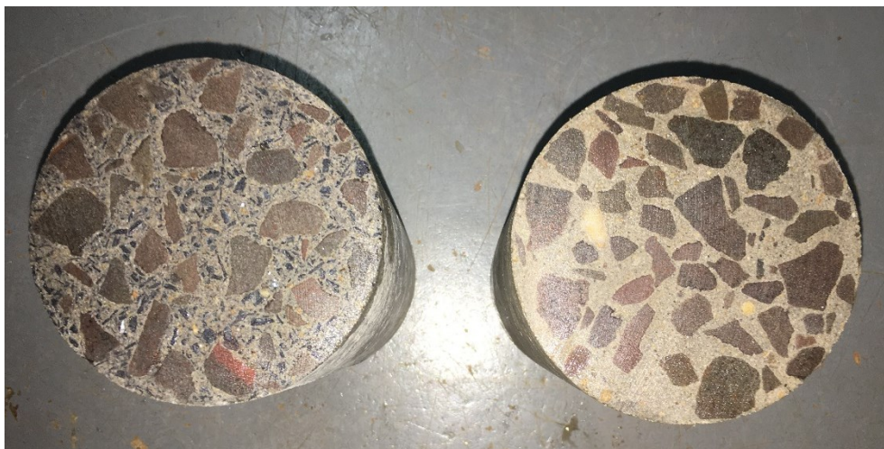
Figura 14 – Concreto 40% carepa, à esquerda, e concreto 0%, a direita
