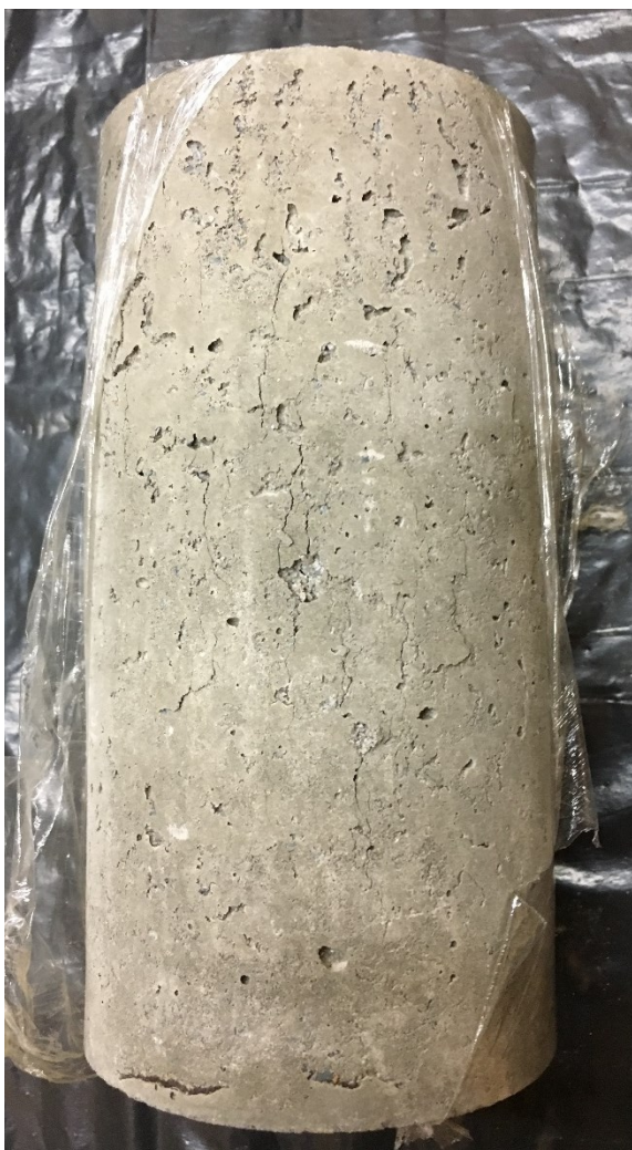
Figura 8 – Fissuras causadas pelo rompimento à compressão
