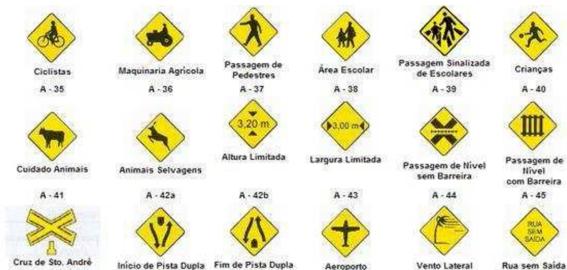
Figura 6 - Placas de advertência
