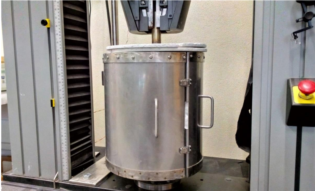
Figura 19 - Forno fixado na base do sistemas de ensaios mecânicos da Instron® série 4485.
