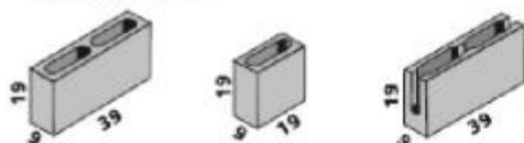
**Figura 4- Alguns tipos de blocos de concreto**
