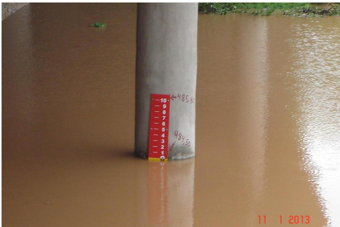
**Figura 23: Nível de água registrado na véspera do escorregamento.**
