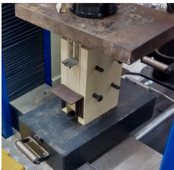
Figura 12 – Execução do ensaio no corpo de prova do modelo 1 da espécie Caixeta.
