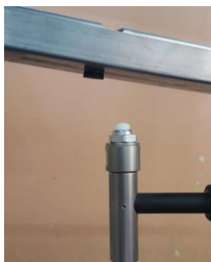
Figura 17 – Martelo de impulso com ponta de plástico e contato de borracha, excitação no GDL 11 (meio do vão).
