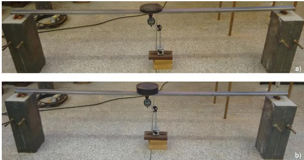
Figura 21 – Esquema estático do ensaio de flexão: a) Carga P_1 ; b) Carga P_{res} = P_1 + P_2 .
