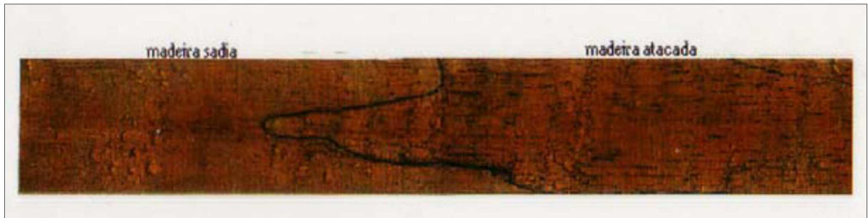
Figura 15 – Aspecto de madeira atacada por fungos de podridão branca Fonte: Moreschi (2013).
