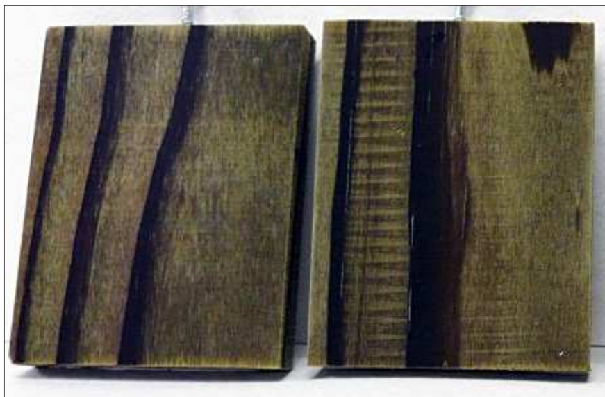
Figura 13 – Fungos manchadores Fonte: Adaptado de IPT – Instituto de Pesquisas Tecnológicas (2015).
