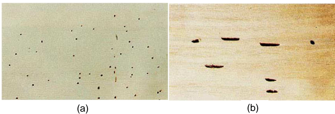
Figura 3 – Perfurações pequenas (a); Perfurações grandes (b) Fonte: Adaptado de Calil, Okimoto e Pfister (2005).
