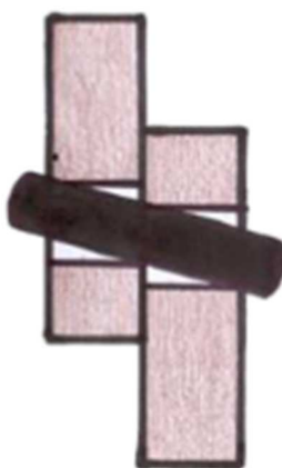
Figura 36 - Modo de falha I do modelo de Johansen para uma seção de corte
