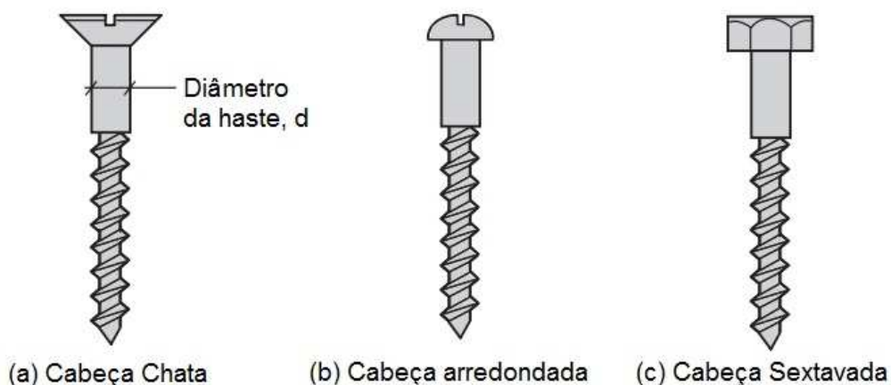
Figura 7 - Tipos de parafusos auto-atarrachantes Fonte: Adaptado Porteous e Kermani (2007).
