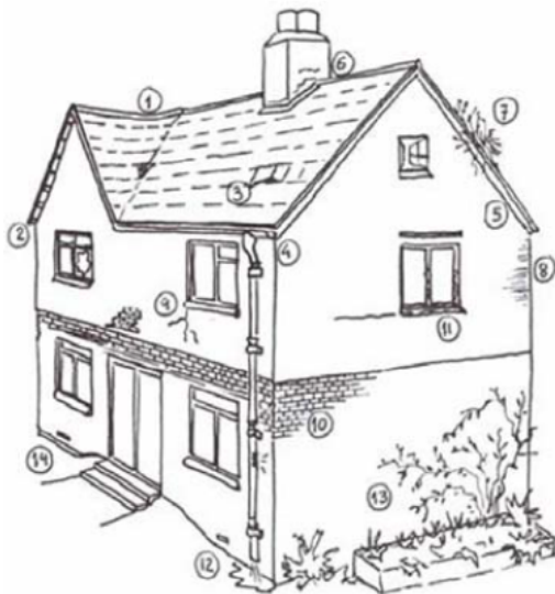
Figura 04. Avaliações externas em edificações: indícios de risco de biodeteriorações. Fonte: ARRIAGA et al (2002) apud BRITO (2014).
