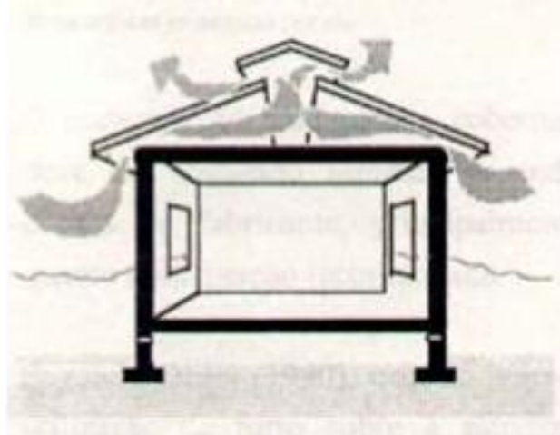
Figura 14. Desenho esquemático da possibilidade de ventilação dos desvãos dos telhados. Fonte: BENEVENTE (1995).
