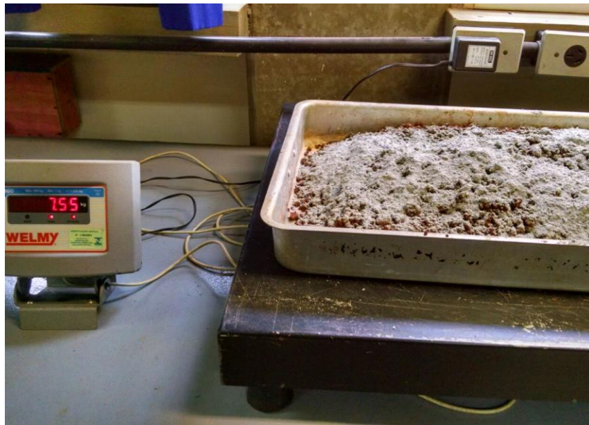
Figura 20. Dosagens de solo e cimento.
