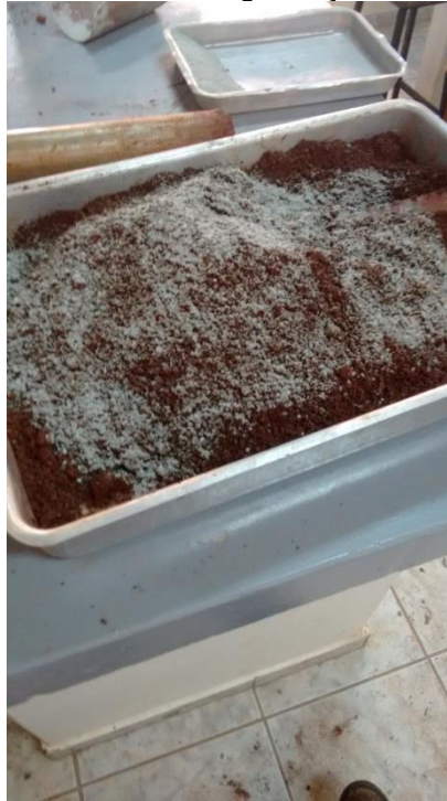
Figura 5 - Início da Homogeneização Solo Cimento
