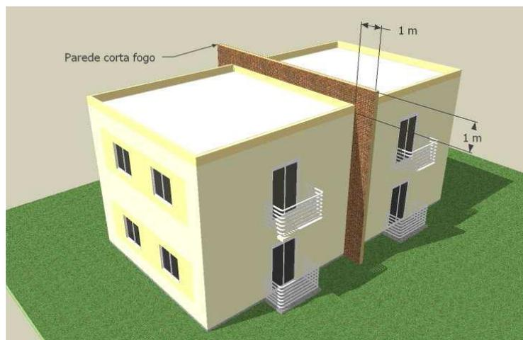
**Figura 4 - Parede corta fogo**
