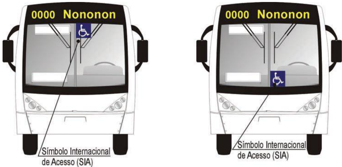
Figura 12 - Exemplo de localização do SIA na parte dianteira do veículo Fonte: ABNT NBR 14022:2009, p.12
