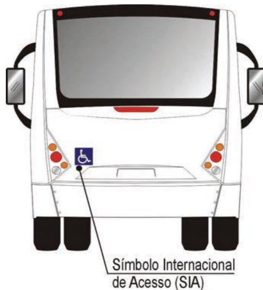
Figura 13 - Localização do SIA na parte traseira do veículo. Fonte: ABNT NBR 14022:2009, p.13
