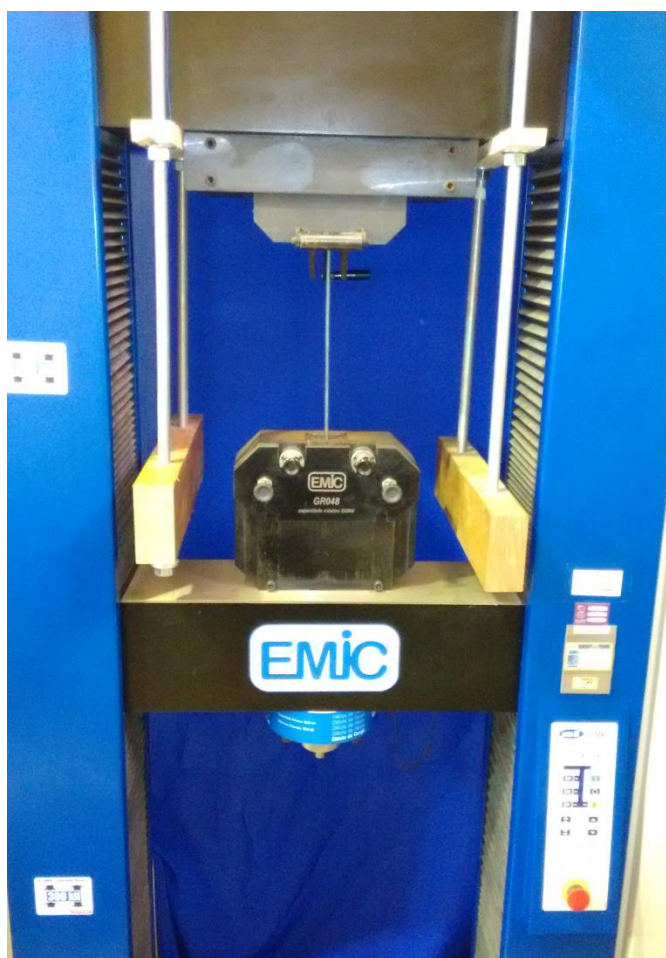
Figura 23 - Ensaio de caracterização do aço
