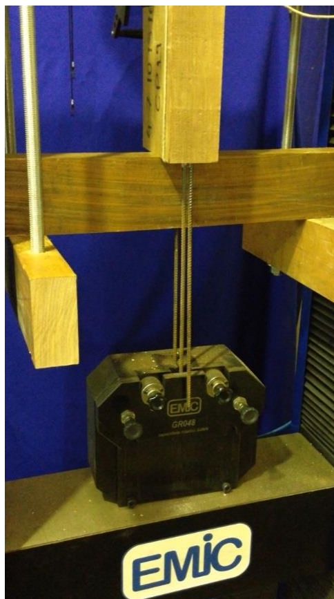
Figura 22 - Ensaio de arrancamento das barras de aço coladas em madeira
