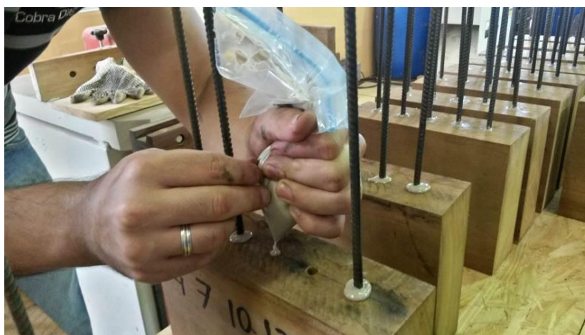
Figura 5 - Colagem das barras de aço nos corpos de prova Fonte: Goto et al. (2014)
