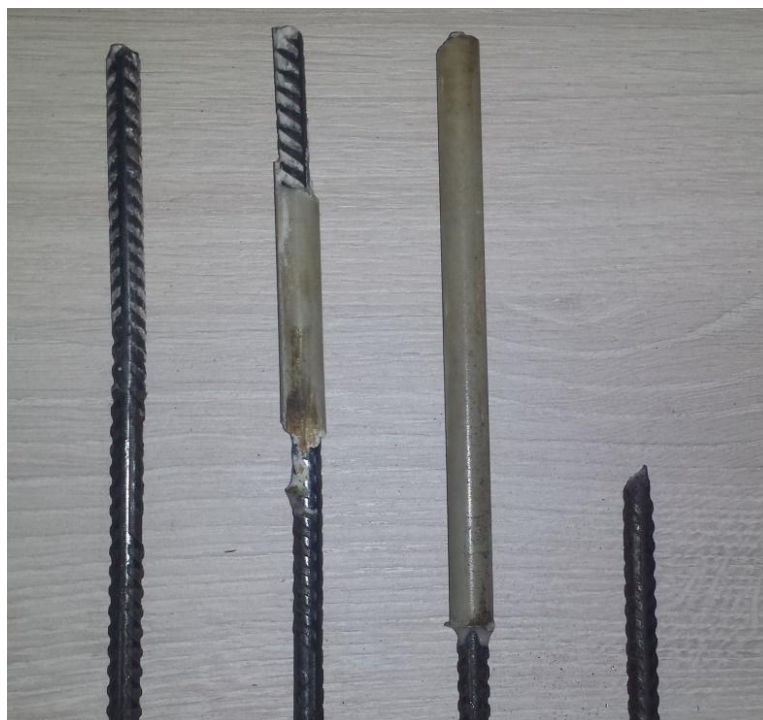
Figura 16 - Modos de ruptura observados por Goto et al. (2014)
